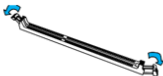
图 4.13 内存条安装步骤 1-2
